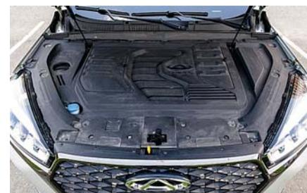
По фирменной традиции двигатель сверху полностью накрыт пластиковым кожухом. Эстетично, но не вполне удобно: чтобы проводить элементарные сервисные операции, «коллак» надо снимать. В отличие от Дашинга, капот удерживают пневмоупоры.
