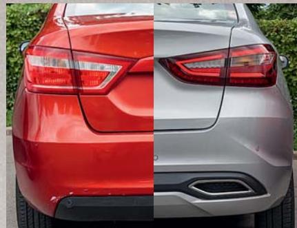
Сзади изменили фонари, бампер и крышку багажника. Переделка старой версии в NG обойдется примерно в те же 120 тысяч рублей, что и для передка. Попутно придется подпилить выхлопную трубу: на новой Весте она короче и спрятана за бампером.
