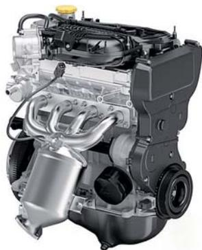
Подъем впускных клапанов вырос на 1,95 мм, выпускных – на 1,55 мм. На 15% увеличено количество попадающего в камеры сгорания воздуха – мотор «разогнали» до 118 л. с. и 151 Н·м.
