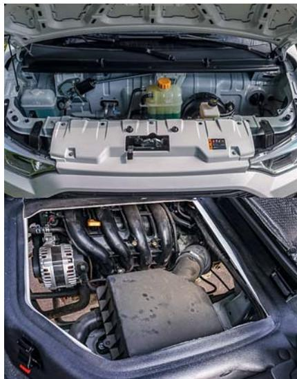
Под «капотом» только расширительный бачок и бачок омывателя. Доступ к двигателю – через салон.
