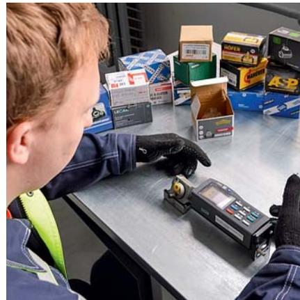
Замер шероховатости внутренней поверхности цилиндра профилометром TR220.
