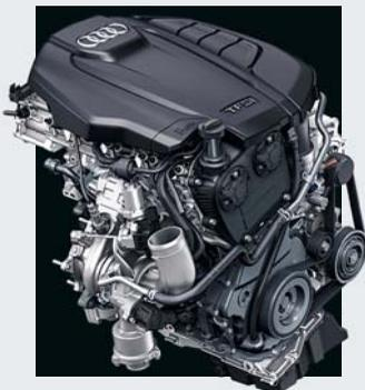
**Турбомотор 2.0 TFSI серии EA888** на дорестайлинговых кроссоверах – наименее удачный в гамме. Его блок цилиндров чугунный, и допускает как расточку, так и гильзование. Но вот расход масла при пробеге около 100 тысяч км может доходить до 7–10 литров на 10 тысяч км. Основа проблемы – в поршневой группе со слишком тонкими и охотно залегающими кольцами. При этом раскоксовка помогает далеко не всегда.
