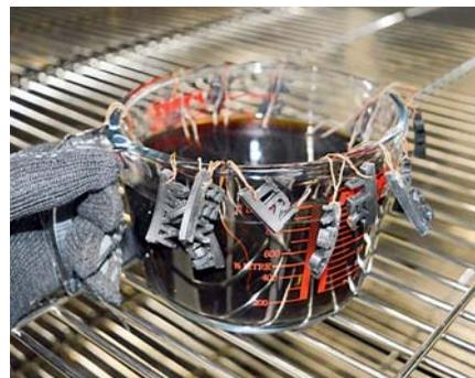
Резиновые компоненты до и после старения в тормозной жидкости.
