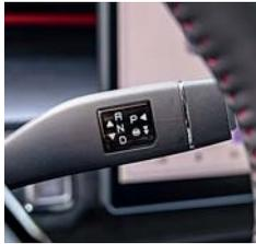
Роботом управляешь по-мерседесовски – правым подрулевым рычажком, но в версиях с базовым мотором 1.5 селектор будет установлен на привычном месте – между передними сиденьями.
