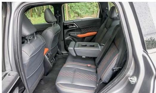
Сиденья второго ряда перемещаются по двум направлениям в широком диапазоне. А вот до потолка места немного. Есть верхние дефлекторы системы вентиляции.
