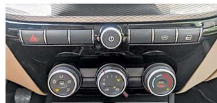
Климат-контроля со стильным реношным блоком нет и, возможно, не будет. Новые крутилки – с механическим приводом, а ведь на дорестайле даже базовое управление отопителем было с электронным пультом.
