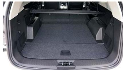
Спинки второго ряда складываются в горизонт – одобряем. В багажнике есть розетка на 12 В, две точки подсветки и даже пульт управления кондиционером в расчете на трехрядную комплектацию.
