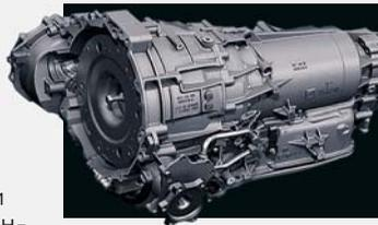
AL651–6Q) на дорестайлинговых автомобилях с мотором 3.2 показывает ресурс около 220–250 тысяч км.
