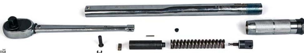
Конструкция щелчкового ключа: преднатяг пружины определяет положение резьбовой рукоятки.
