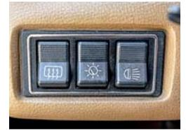
Кнопки освещения и обогрева заднего стекла скомпонованы в единый блок.
