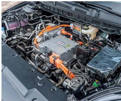
E-QM5 разрабатывался исключительно как электромобиль. В базовом варианте мотор выдает 136 сил, а в батарее 54 кВт·ч, поэтому исполнение на 190 «лошадей» и 82 кВт·ч выглядит единственным достойным внимания для такой большой машины. Запас хода – 435 и 605 км соответственно по устаревшему циклу CLTC. Привод бывает только передним.
