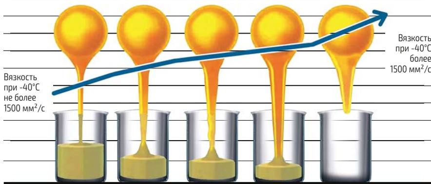
Жидкость с высокой вязкостью густеет при отрицательных температурах, и её трудно про-
