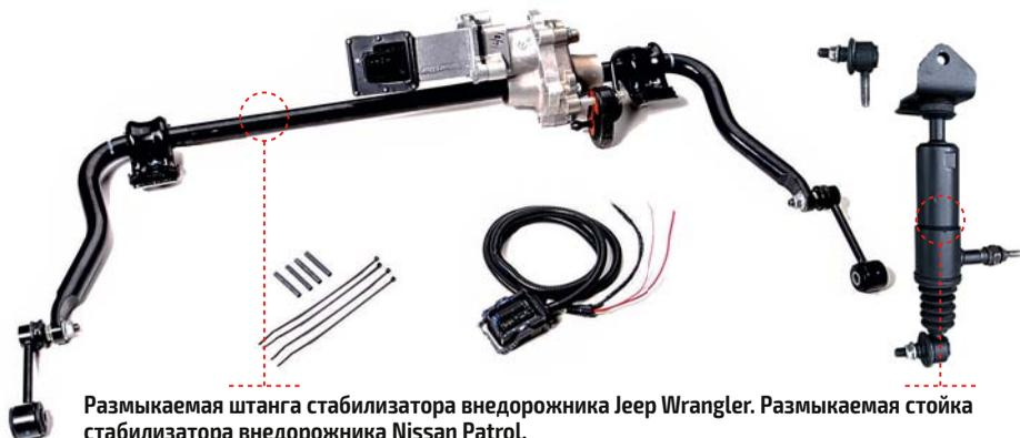
Размыкаемая штанга стабилизатора внедорожника Jeep Wrangler. Размыкаемая стойка стабилизатора внедорожника Nissan Patrol.
