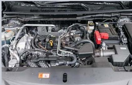
Двигатель PR2500 с непосредственным впрыском дебютировал относительно недавно. Оснащенные им модели даже в США и Азии пока не успели набрать солидных пробегов, чтобы оценить надежность. Из гарантированных проблем – нагар на впускных клапанах.
