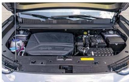
На клапанной крышке – эмблема Chery: мотор-то оттуда. И семиступенчатый робот – тоже. Доступ ко всем узлам и горловинам хороший. Бачок для стеклоомывайки непроизвольно мелкий – всего 1,13 л, притом что вокруг места хватает и на стандартные 5 л.
