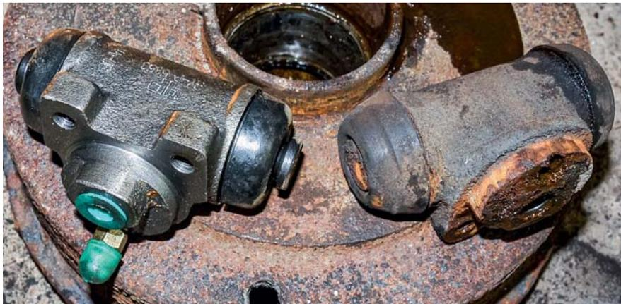
Мы испытали 15 задних тормозных цилиндров для популярных автомобилей на платформе В0. Увы – для замены годятся только некоторые из них.
