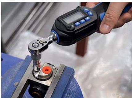
Определяем крутящий момент отворачивания штуцера – как в исходном состоянии, так и для оценки воздействия коррозии.
