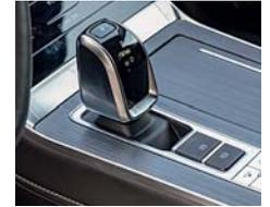
Нефиксируемый селектор трансмиссии и площадка с беспроводным зарядником рядом с ним - классика жанра.
