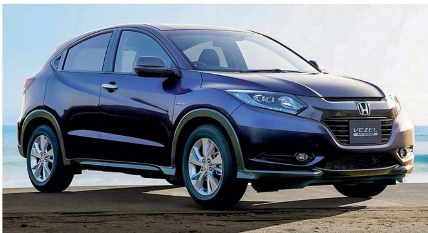
**i** В Европе и Америке называется Honda HR-V, в Китае – XR-V. Общие платформа и агрегаты с хэтчбеком Fit. Наиболее массово пока представлена гибридная версия. Привод передний или полный. Уже в базовой комплектации есть комплекс Honda Sensing: адаптивный круиз-контроль, системы удержания в полосе и предотвращения столкновений.
