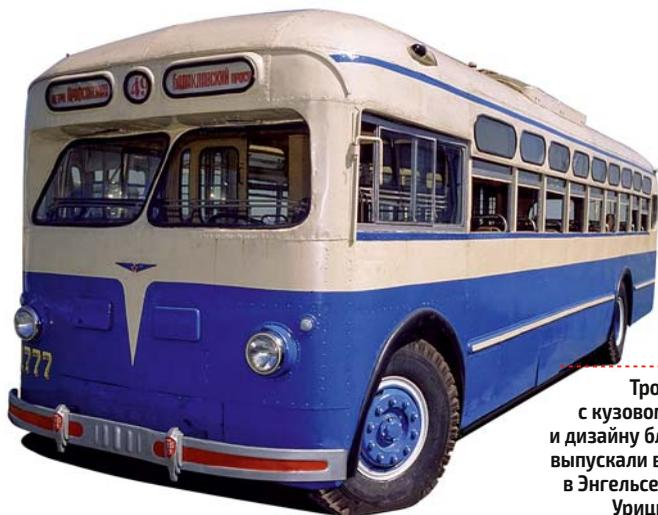
Троллейбус **MTB-82**, с кузовом по конструкции и дизайну близким к ЗИС-155, выпускали в Москве, а потом в Энгельсе на Заводе имени Урицкого (ЗИУ) вплоть до 1961 года.
