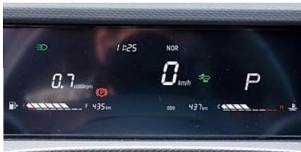
Приборка – узкий дисплей, на который все данные выводятся в цифровом виде. Менять конфигурацию нельзя.
