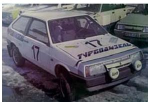
машины – трехдверный ВАЗ-210834 и пятидверный ВАЗ-210934. На них продольно, на оригинальной раме стоял силовой агрегат Нивы ВАЗ-21213. Автомобили имели обе независимые подвески и дисковые тормоза на всех колесах.
