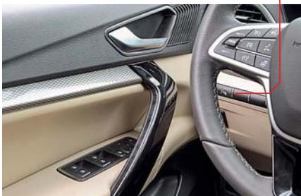
Тактильно клавиши стали более «породистыми». А вот авторежим для передних стеклоподъемников исчез. Нет и электроскладывания зеркал, которые пока стоят в старых корпусах. Обещают вернуть со временем. Парктроник теперь отключаемый. Количество заглушек навевает грусть.
