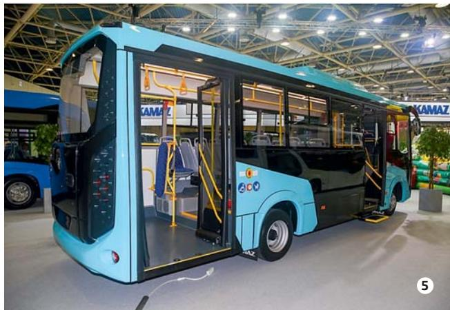
Линейка среднетоннажников КамАЗ Компас на базе грузовичков JAC расширена небольшой моделью **Компас 5**. Среди примерно тридцати новинок, показанных КамАЗом на выставке, была даже экспериментальная пневмоподвеска для линейки Компасов, чья полная масса может достигать 12 тонн. Простой жизни у Валдаев не ожидается!
