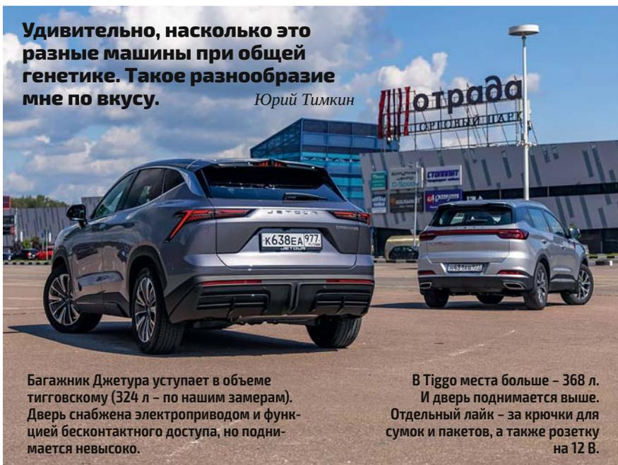
Багажник Джетура уступает в объеме тигговскому (324 л – по нашим замерам). Дверь снабжена электроприводом и функцией бесконтактного доступа, но поднимается невысоко.
